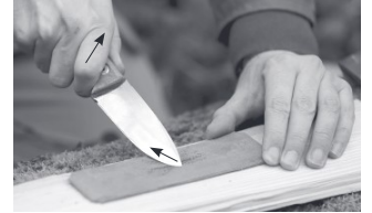
3. Schritt: Ziehbewegung beim Messerschärfen
